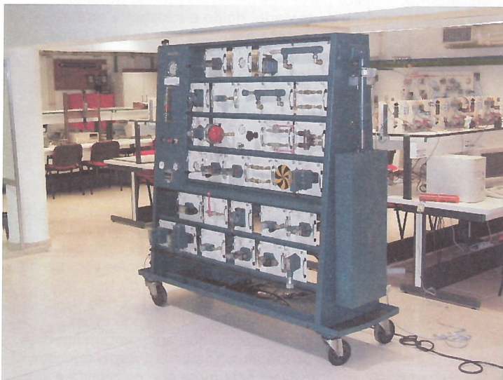
Bancada hidráulica (funciona com óleo sob pressão)
