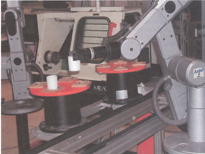
Robô preparado para controlo de força (em cima e em baixo)
